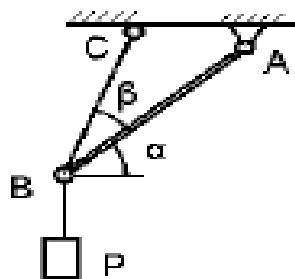
2. Груз весом  $P = 10 \text{ Н}$  подвешен на двух тросах АВ и ВС, составляющих с горизонтальной прямой углы  $\beta=15^\circ$  и  $\nu=30^\circ$ . Определить усилия в тросах.
